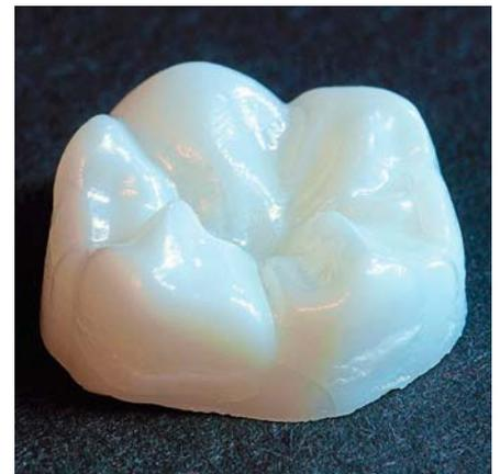
Additiv gefertigte Okklusalfäche eines Backenzahnes in gebranntem Zustand
